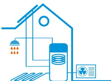
Podna jedinica sa integriranim ECH<sub>2</sub>O toplinskim spremnikom
